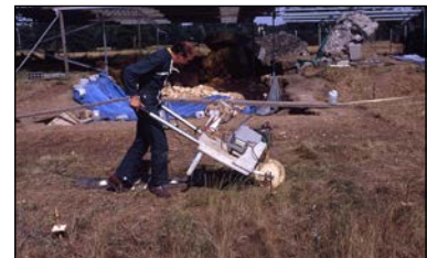
Les prospections électriques ont montré la faible profondeur du sol naturel dans l'axe des monuments.
