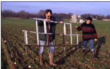
Les prospections électriques ont montré la faible profondeur du sol naturel dans l'axe des monuments.
